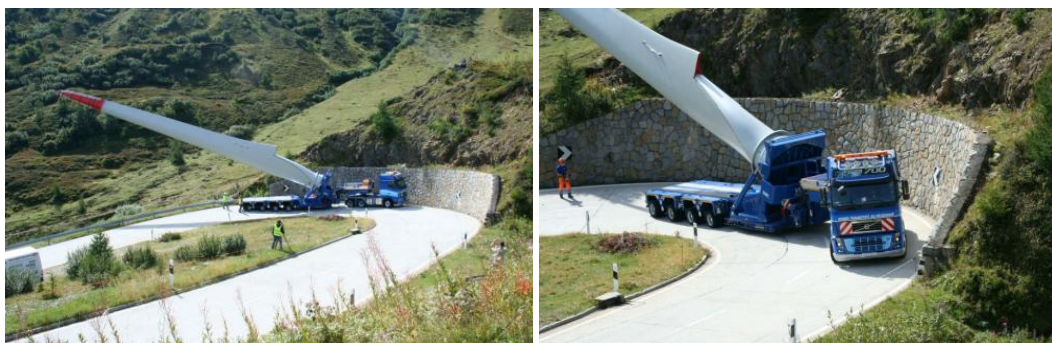
Abbildung 7: Spezialtransport für eine Windenergieanlage am Griespass [CH].
